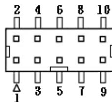
**SPI1: SPI Header**
