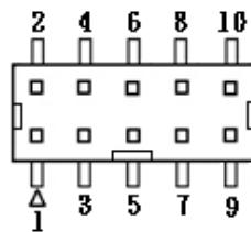
**SPI1: SPI Header**
