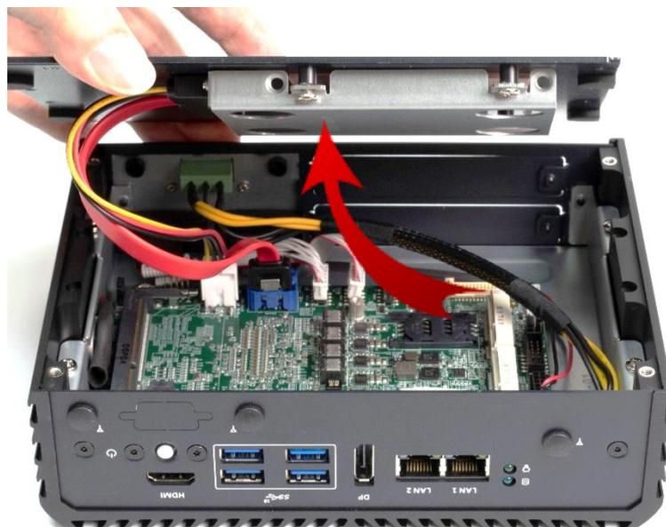
**3. Remove the sata cable 、 power cable & remove the bottom cover.**
